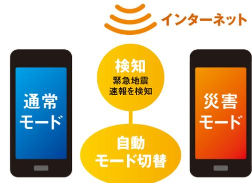
**緊急地震速報に連動。自動的に災害モードへ切り替わります。**
